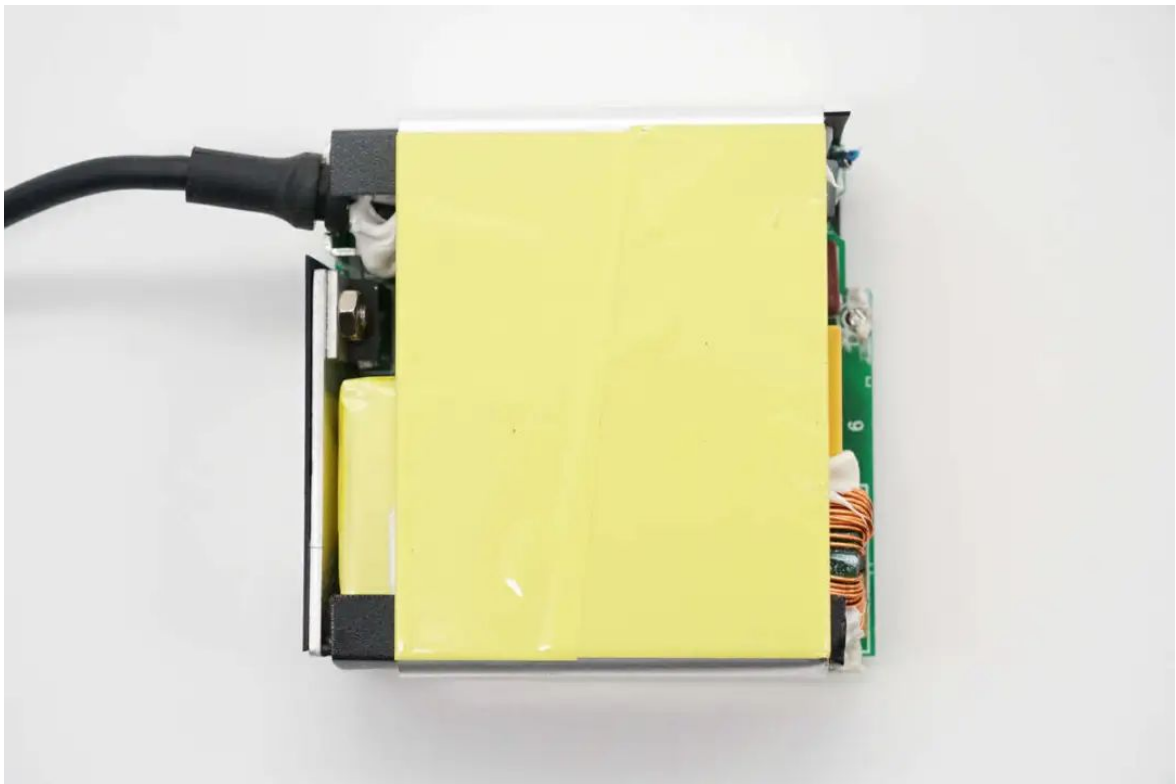
抽出内部PCBA模块，散热片缠绕黄色胶带掬月按。
