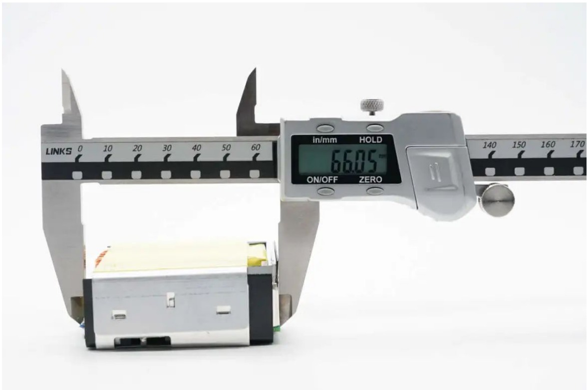
使用游标卡尺测得PCBA模块长度约为66mm。
