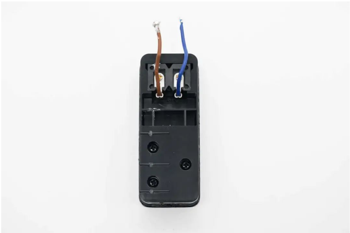
导线焊接连接到输入插座。
