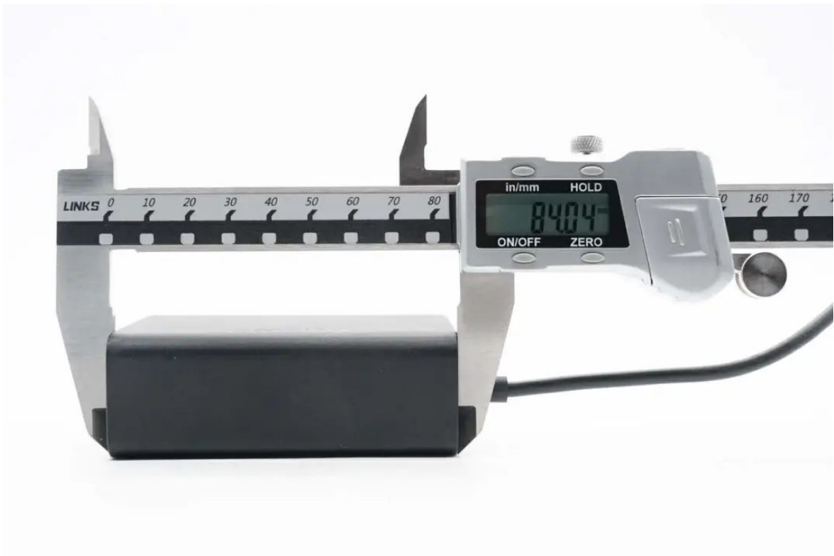
实测华为65W电源适配器机身长度为84.04mm。
