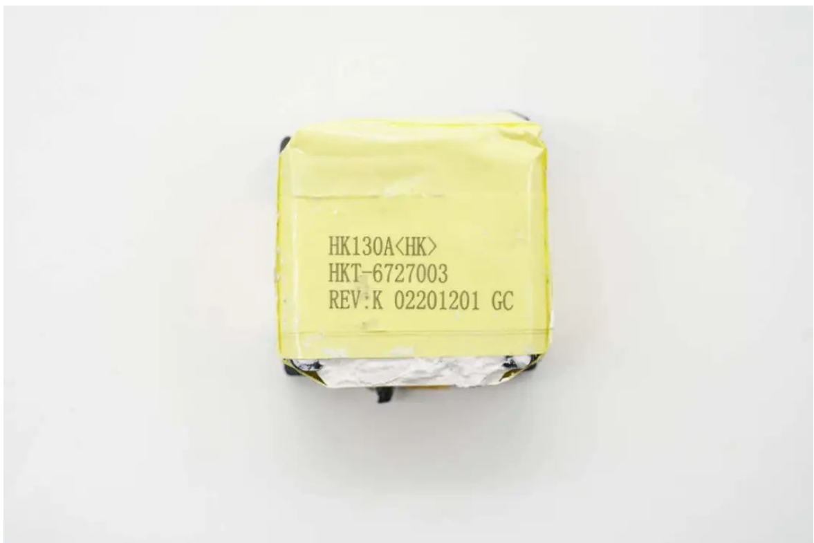
变压器采用胶带严密缠绕绝缘。
