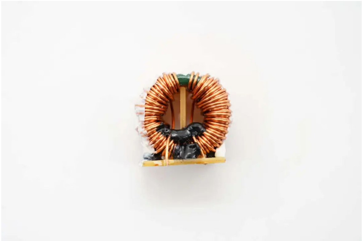
共模电感底部粘贴电木板绝缘。
