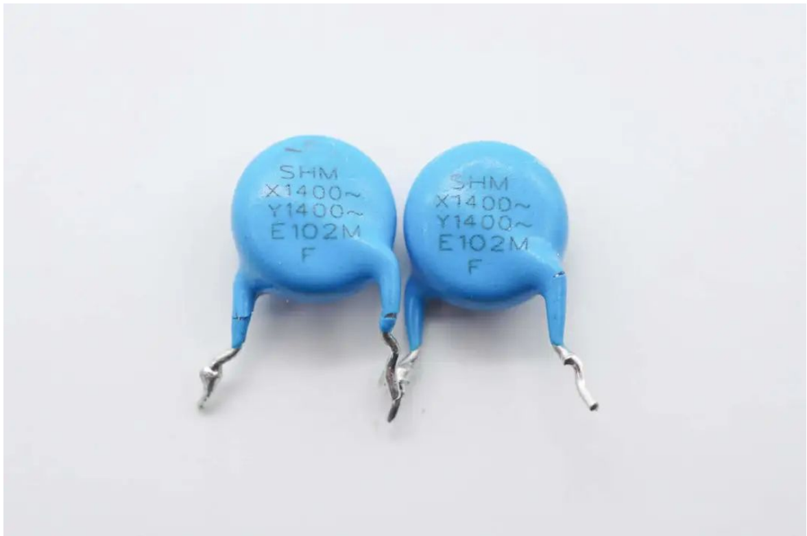
安规X2电容来自南方宏明，两颗串联，提高耐压等级。
