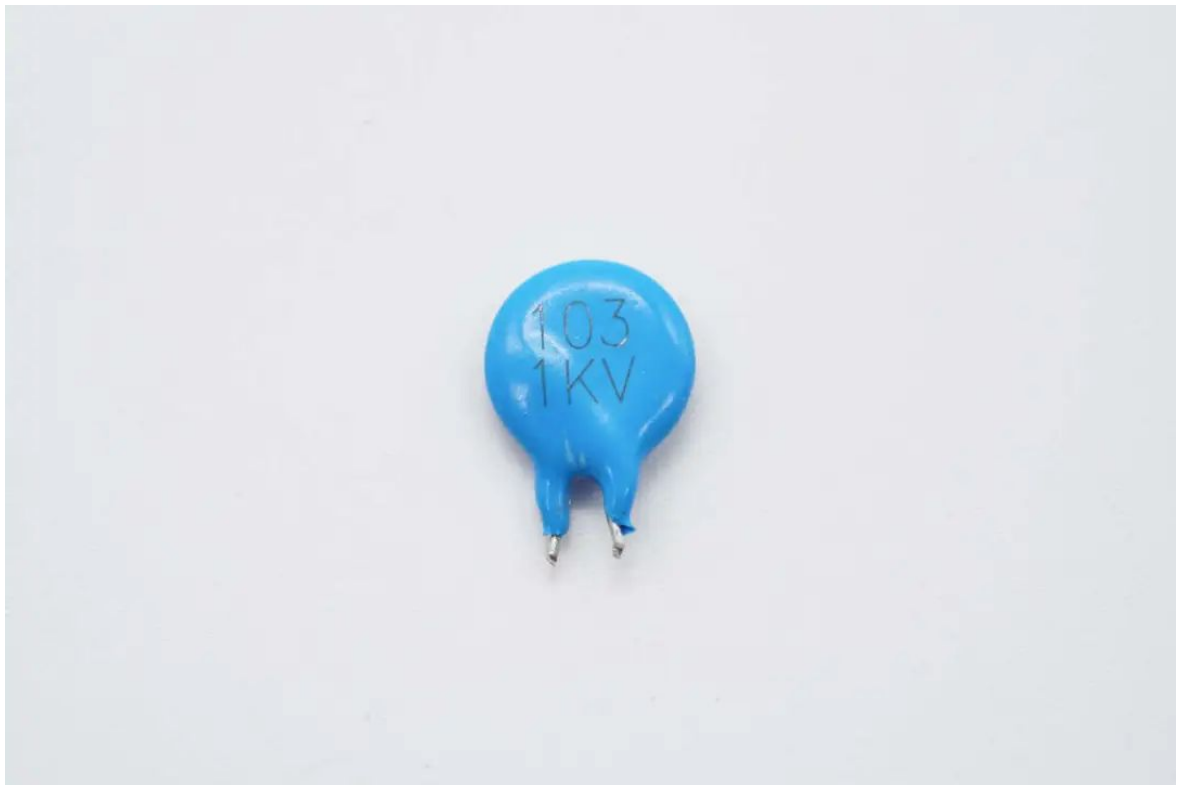
103瓷片电容与高压滤波电容并联。
